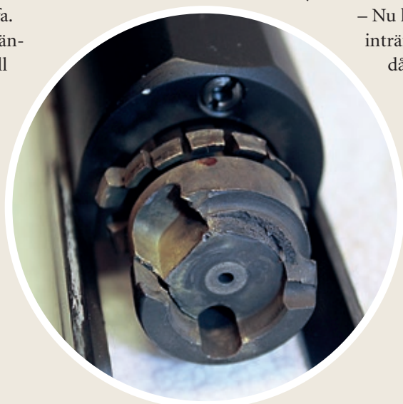
En stor del av slutstyckshuvudet fastnade i patronläget när studsaren exploderade och slutstycket slungades bakpå och skadade Christer Svensson.
